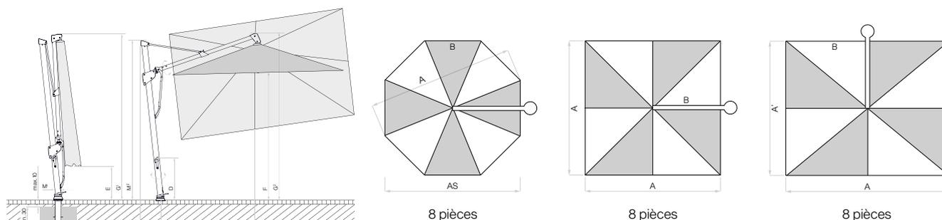
Revêtement de chaussée non fixé max. 10 cm, épaisseur du béton min. 30 cm (tenir compte de la profondeur hors gel), Garantir l'écoulement de l'eau
